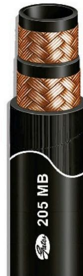
**Recomendada para usarse en:** Procesos industriales que requieren manejar vapor saturado hasta 250 psi de presión, con mínimas perdidas de calor como en los sistemas de limpieza. Los diferentes elementos de esta manguera tienen una resistencia sobresaliente al calor. La cubierta está picada para permitir la permeación del vapor y evitar burbujas que pueden explotar y causar accidentes.
