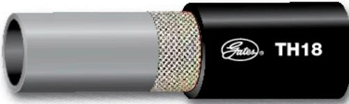
**Tubo:** Elastómero de Poliéster.**Refuerzo:** Una banda de fibra sintética.**Cubierta:** Poliéster especial, negra y perforada.**Rango de Temperatura:** -55°C a +100°C (-67°F a +212°F) en servicio continuo para petróleo y aceites sintéticos. Máximo de +70°C (+158°F) para fluidos a base de agua.**Conexión Recomendada** ((Ver Manual de Crimpado 35019 o E-crimp):
